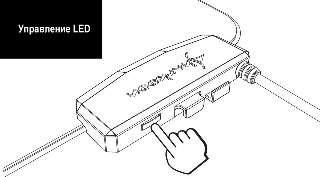
При выключенном освещении, нажмите кнопку на контроллере 2 раза подряд, чтобы включить подсветку. Предустановленный режим - «Непрерывный» (см. «Режимы освещения ниже»), а зеленый - как цвет по умолчанию. Нажмите на кнопку контроллера 1 раз, чтобы поменять цвет. Цветовая последовательность следующая: зеленый, красный, синий, желтый, голубой, фиолетовый и белый. Нажмите и удерживайте кнопку, чтобы уменьшить яркость. Нажмите кнопку контроллера дважды, чтобы перейти к следующему режиму подсветки.
